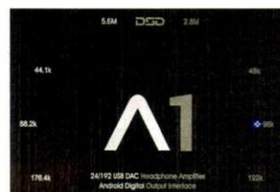
ポータブルデバイスとの組み合わせに最適なスリムボディは、ヘアライン加工が高級感を演出するアルミ仕上げのパネルと、マットな感触のABSプラスチックの組み合わせで質感も上々。天面パネルには、LEDインジケーターが配されており、入力信号を一目で確認することが可能だ。
